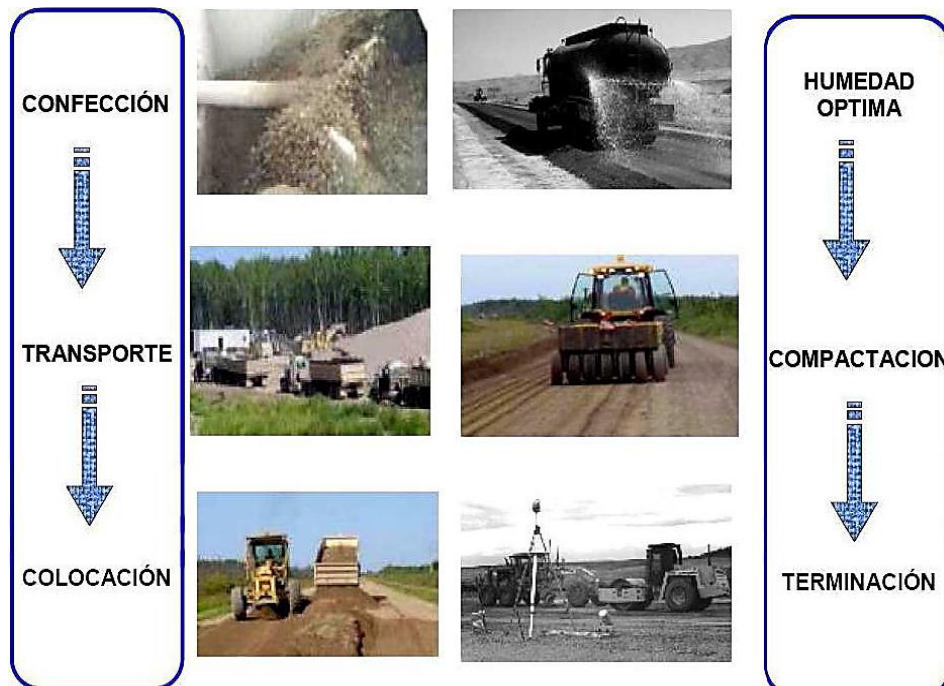
Figura 3. Etapas para la preparación de la base Fuente: Miranda, 2010
