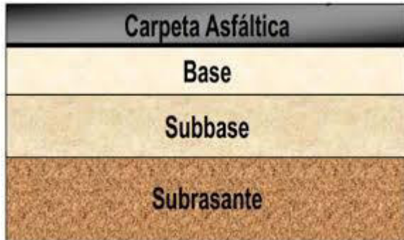
Figura 1. Esquema de un pavimento flexible Fuente: Ortiz, 2017
