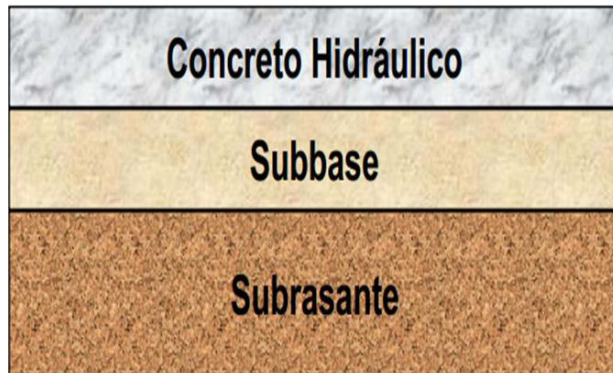
Figura 2. Esquema representativo de un pavimento rígido Fuente: Inciarte, 2012
