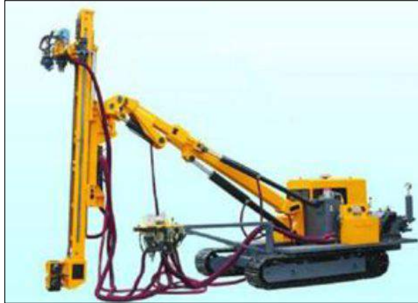
Figura N°04.- Máquina de Perforación Diamantina. Fuente: Huanghaijixie S.A.A., (2015).
