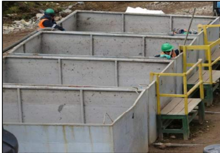
Figura N°32. Tanques para el almacenamiento de lodos de perforación. Fuente: Compañía Minera Milpo S.A.A, (2015)
