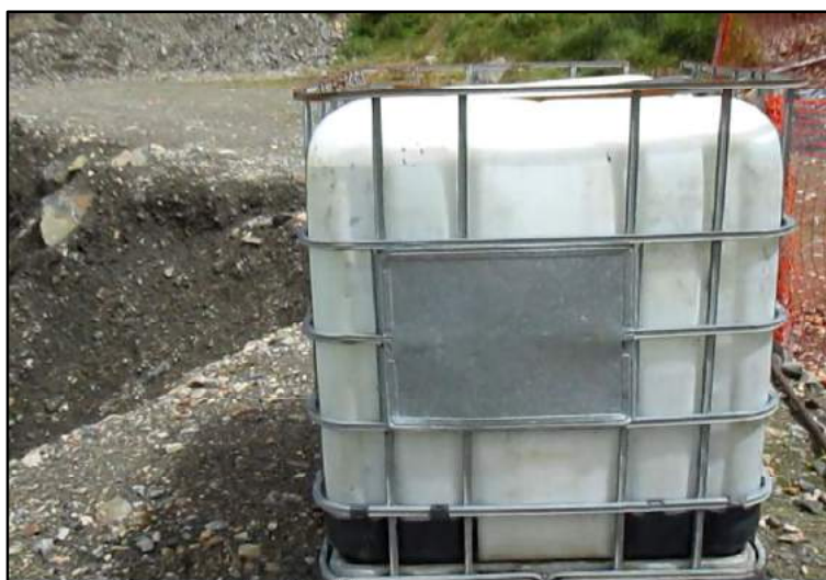
Figura N°33. Tanque IBC para almacenamiento de agua pura. Fuente: Proyecto de Exploración Minera Hilarión, (2015).
