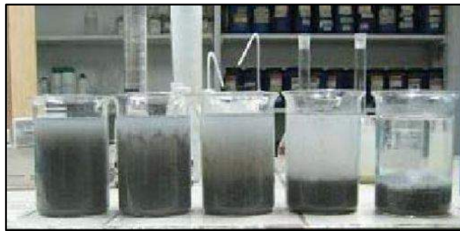
Figura N°35. Determinación de la dosis del Coagulante. Fuente: Mercantil S.A., (2013).
