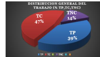
Nota: En esta tabla se muestra la carta balance conforme a la partida de encofrado metálico, la cual indica un porcentaje de TC del 39%, TNC del 14% y TC del 47%
