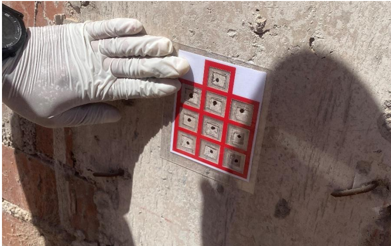
Figura 15. Trazo de 10 puntos de ensayo con plantilla
