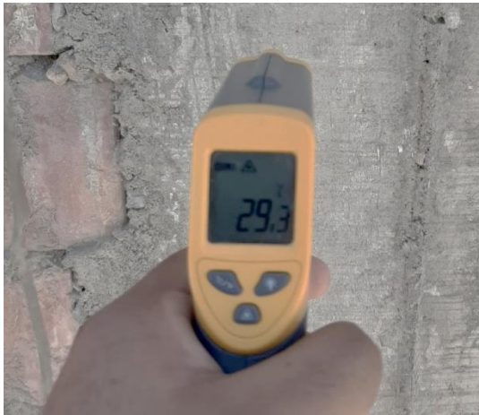
Figura 13. Medición de temperatura de la columna de concreto con termómetro digital
