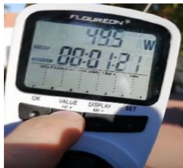
Figura 3 Medición luminaria LED 40 W.
