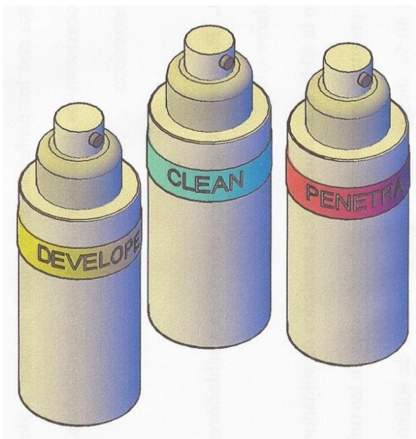
Figura 23. Juego de tintes: limpiador, penetrante y revelador.
