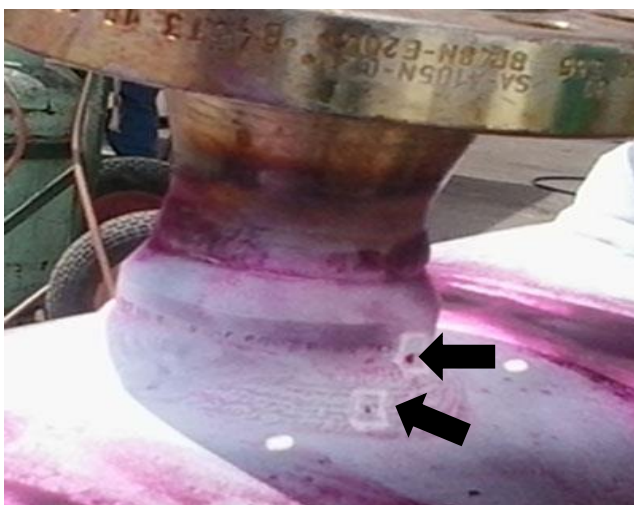
Figura 25. Aplicado el revelador se muestra discontinuidades. Fuente: Villamil, 2017.
