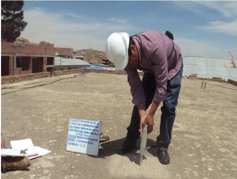
Figura 19. Toma de muestra pruebas con esclerómetro de losa aligerado segunda planta
