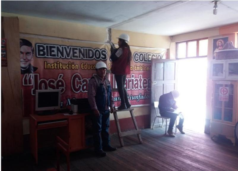
Figura 17. Toma de muestra prueba de esclerómetro la viga de primera planta
