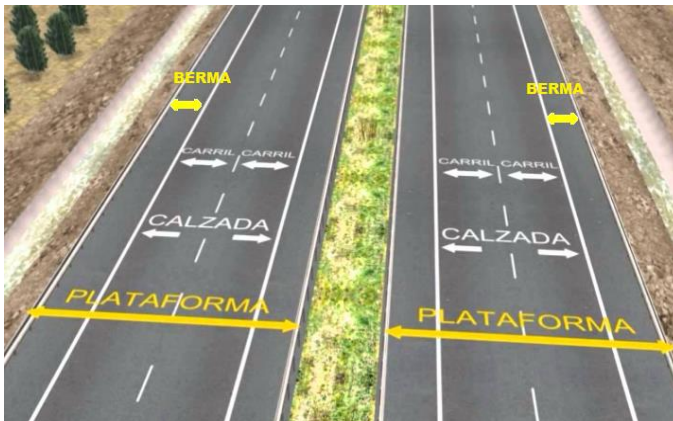
Figura 22. Partes de la vía
