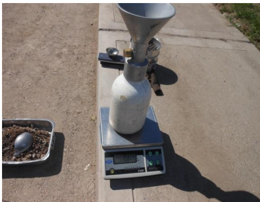
Figura 91. Ensayo densidad de campo, lado izquierdo de la berma de la Av. Malecón Ribereño, progresiva 1+160 @ 2+160
