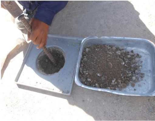
Figura 90. Ensayo densidad de campo, lado derecho de la berma de la Av. Malecón Ribereño, progresiva 1+160 @ 2+160
