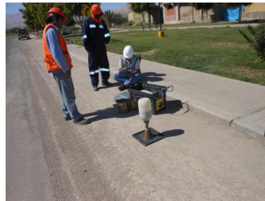
Figura 91. Ensayo densidad de campo, lado izquierdo de la berma de la Av. Malecón Ribereño, progresiva 1+160 @ 2+160
