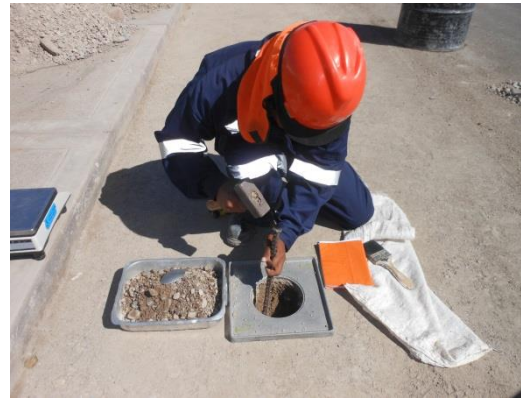
Figura 90. Ensayo densidad de campo, lado derecho de la berma de la Av. Malecón Ribereño, progresiva 1+160 @ 2+160
