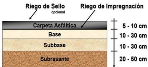
Figura 3. Corte transversal de un pavimento flexible Fuente: Cámara Nacional del Cemento, 2015
