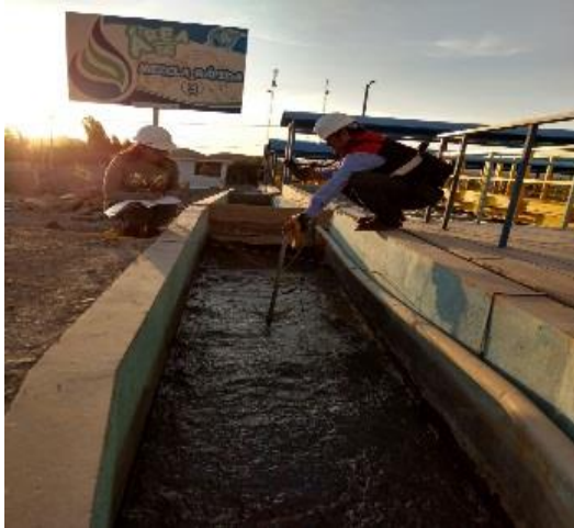
Figura 26. Midiendo la velocidad de la subsección 2 del canal
