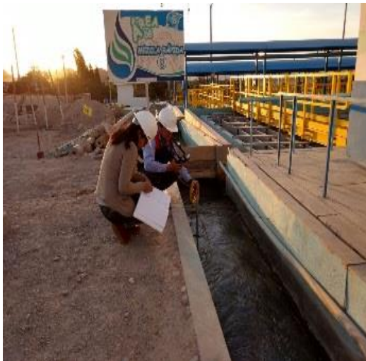
Figura 27. Midiendo la velocidad de la subsección 3 del canal
