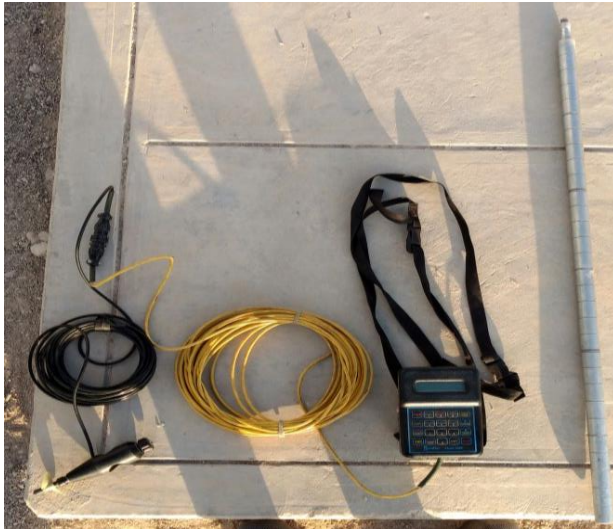
Figura 15. Pantalla swoffer 3000 con varillas combinadas métricas Nota: Equipo prestado de Proyecto especial Regional Pasto Grande
