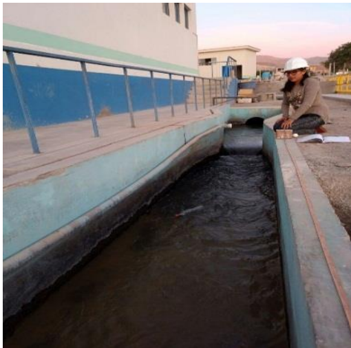
Figura 30. Medición del tiempo recorrido del flotador
