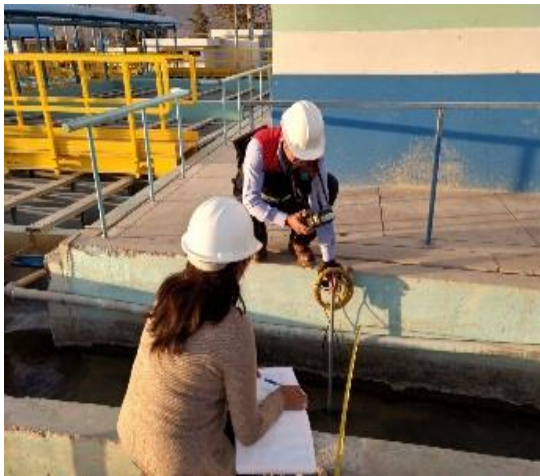
Figura 25. Midiendo la velocidad de la subsección 1 del canal
