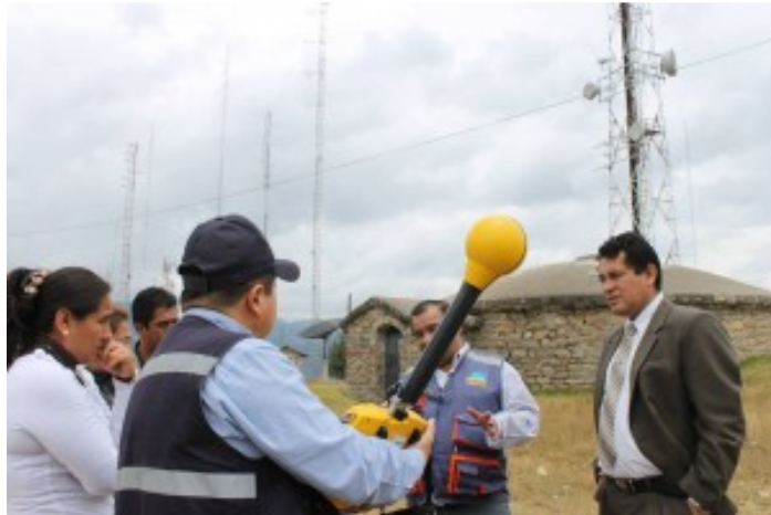
Figura 23. Mediciones de RNI hecho por el MTC
