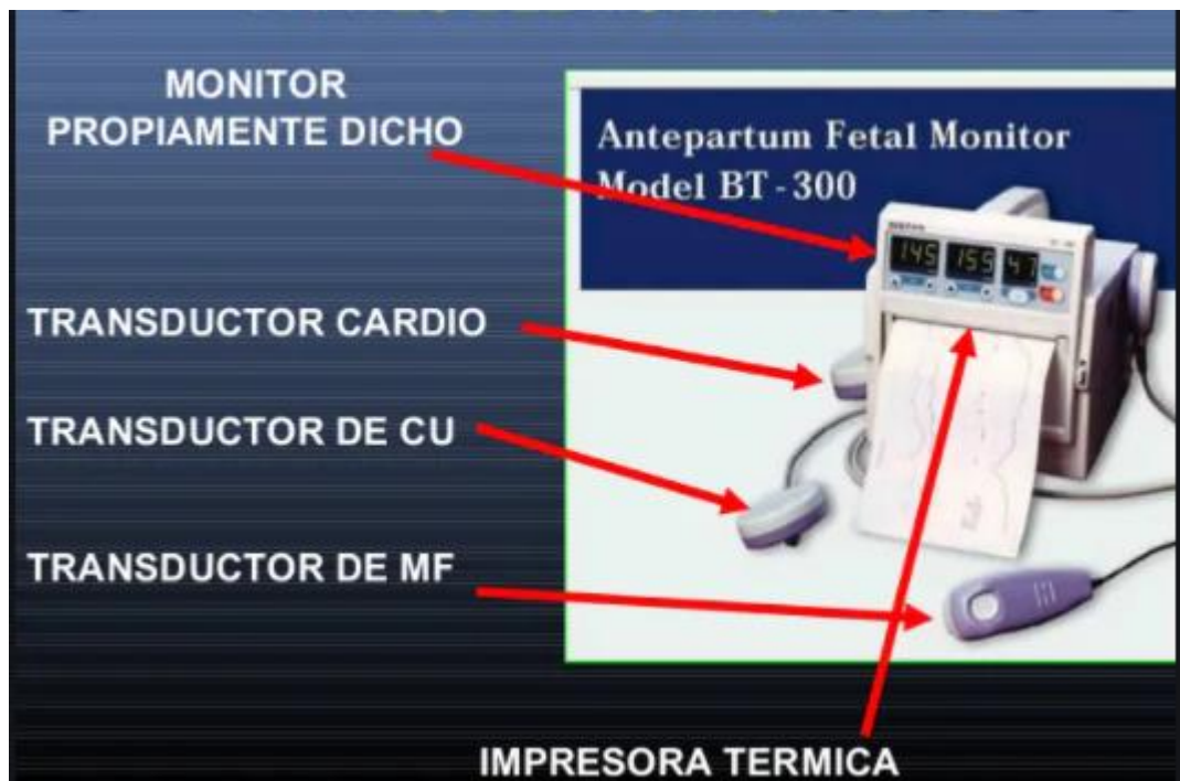
Figura 6. Partes del monitor fetal
