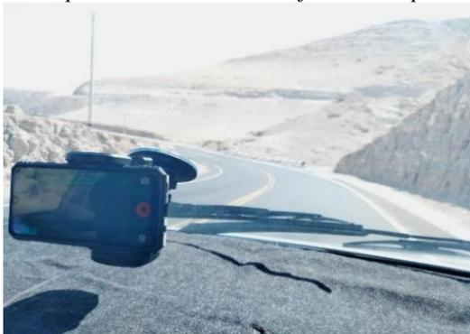
Previo a cada muestreo se pulsó el botón amarillo para calibrar el smartphone en las coordenadas X, Y, Z para lograr que los valores sean igual a cero, esto para que únicamente el plano vertical sea tomado como el eje de referencia con respecto al cual se desea medir las vibraciones, esto se puede observar en la Figura 21.
