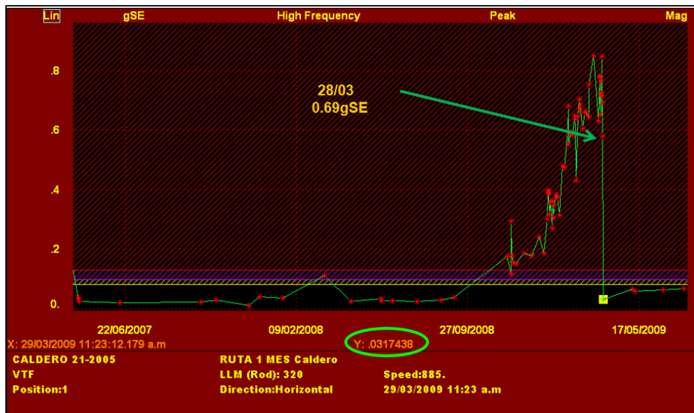
Figura 69. Tendencia de vibración después del cambio de rodamiento.
