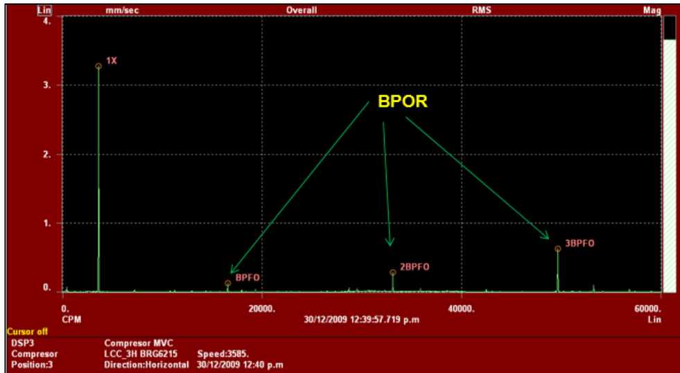
Figura 41. Espectro identificando frecuencia de falla BPOR
