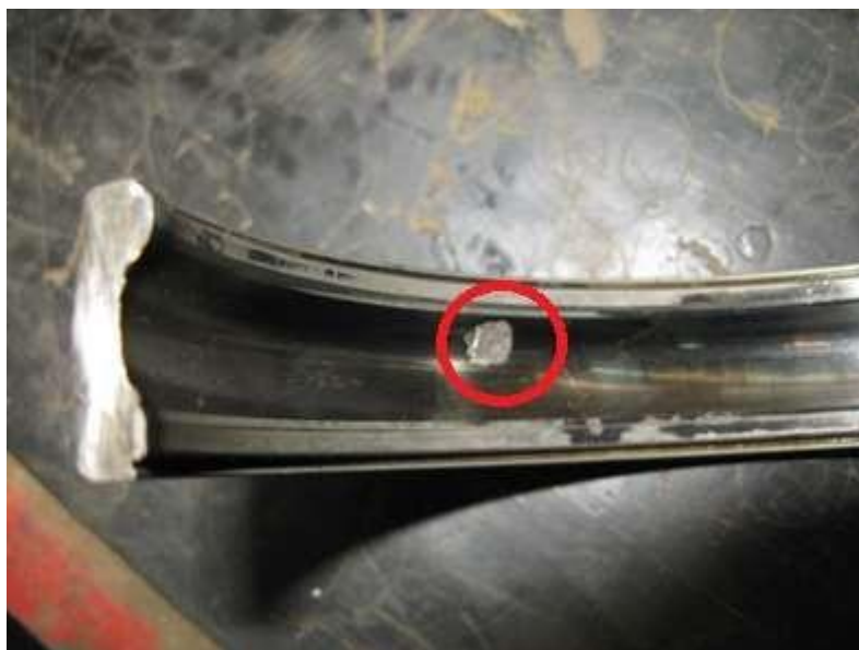
Figura 43. Daño encontrado n pista exterior de rodamiento
